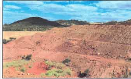
Bild 2: Vorratshalden (Stockpiles) von limonitischem Erz im Nickel-Tagebau Barro Alto von Anglo American Nickel in Goiás, Brasilien Foto: DERA
